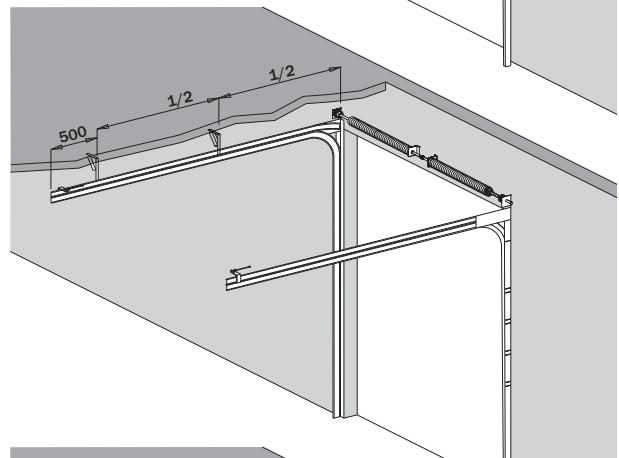
**CZ Nad výšku vrat 4 000mm nebo plochy vrat větší jak 20m<sup>2</sup>, je potřeba min. tří horizontálních ukotvení u každé kolejnice.**
