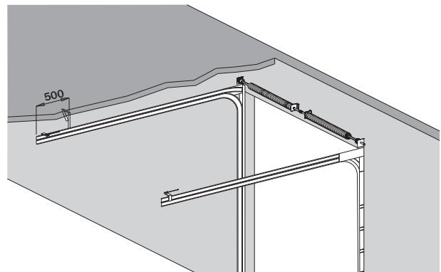
**CZ Nad výšku vrat 3 510mm nebo plochy vrat větší jak 12 do 20m<sup>2</sup>, je potřeba min. dvou horizontálních ukotvení u každé kolejnice.**
